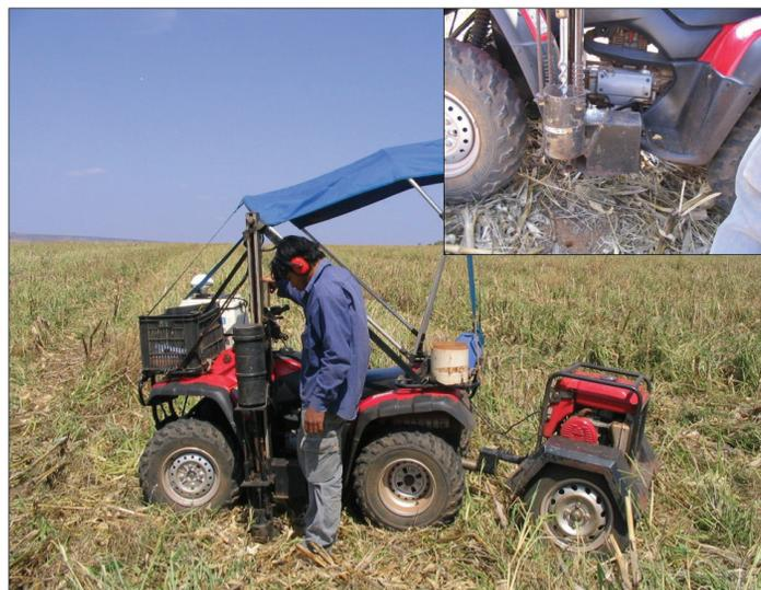
**Figura 4.** Amostrador hidráulico tipo broca (foto menor) montado em quadriciclo – equipamento comumente utilizado na amostragem georreferenciada de solo. O GPS é o dispositivo de cor branca acoplado à frente do veículo, ao lado da caixa de armazenamento de amostras.
